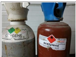
Il est utilisé pour la réalisation de soudure, de découpe de métaux ou d'analyse chimique. Son utilisation la plus fréquente est en plomberie, au moyen de postes oxy-acétyléniques, constitués d'un ensemble de deux bouteilles en acier, une d'acétylène et une d'oxygène.
